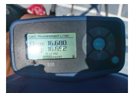
ตรวจสอบ Flow Calibrate for PM-10
